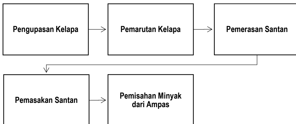
Gambar 1. Proses Pengolahan Kelapa menjadi Minyak Kelapa
